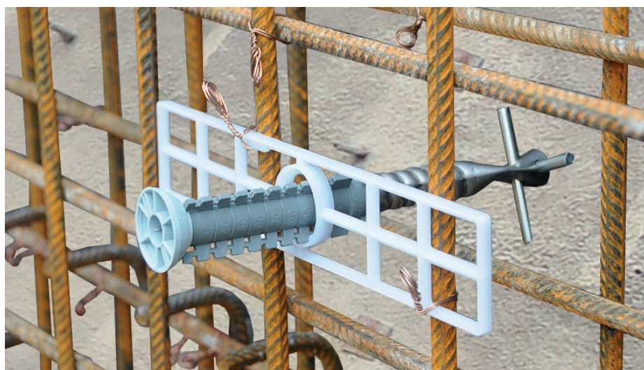
Bei der Sicherung von Spundwänden kann der V2A UNI-Betonanker auf die Bewehrung gebunden werden und dient danach als Anker für eine Einhäuptige Schalung.
