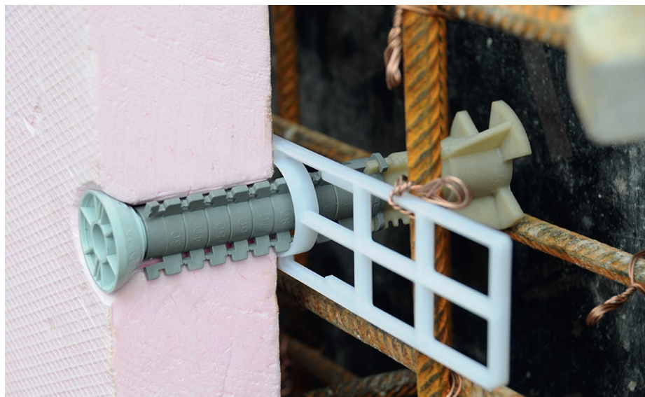
Mit der Verlängerungshülse und der Montageplatte erhöht sich die garantierte Gebrauchslast der UNI-Betonhülle auf 4.5 Tonnen und kann auch da verwendet werden, wo die Isolation in die Schalung eingelegt werden muss.
