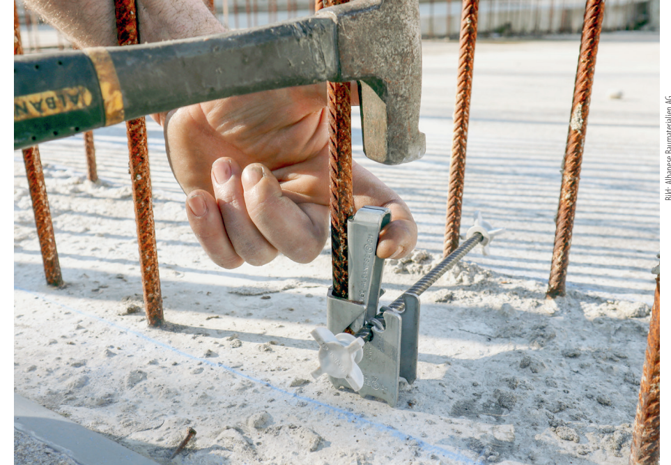
Der Anschlag- und Distanzhalter für Wandschalungen «RISA V-20» besteht aus nur zwei Teilen und passt sich automatisch an Anschlussseisendurchmesser von bis zu 20 Millimetern Durchmesser an.
